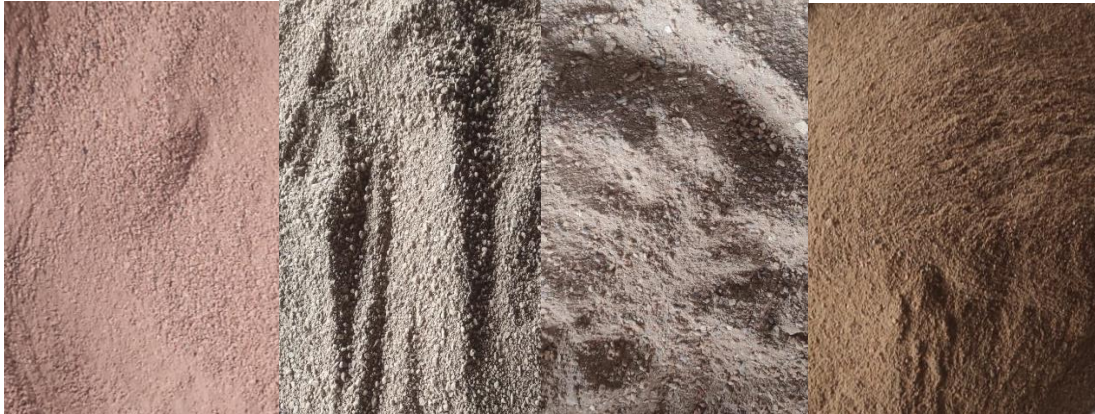
Figura 22. Preparación de barro, fuente: elaboración propia. Nota: preparación de barro: 1) arcilla cocinada pulverizada. 2) tierra con adecuada cantidad de arcilla .3) ceniza volante o ceniza de carbón. 4) mezcla de tierra, arcilla cocida y ceniza volante.
