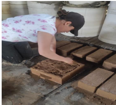
Figura 29. moldeo de adobes reforzados con fibra de coco, fuente: elaboración propia.
