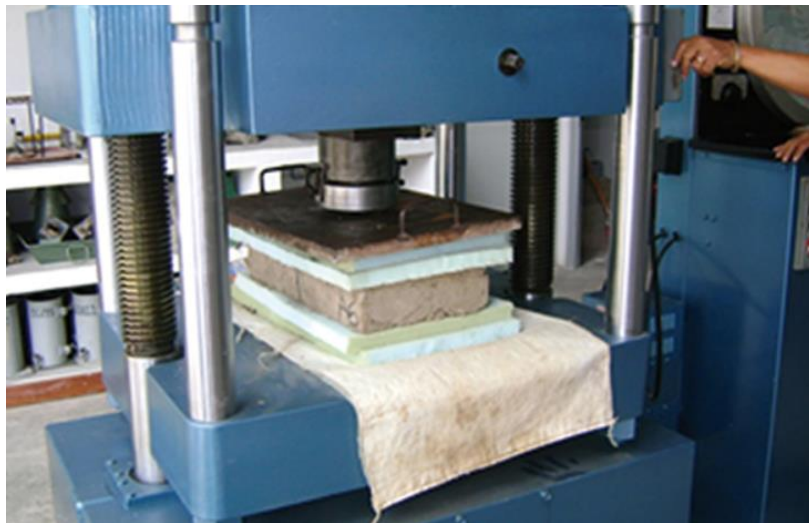
Figura 39. Prueba de compresión de adobe de ejemplo, fuente: tomada prueba de compresión de adobe de ejemplo. Ovando de la Cruz y Ruiz Castellanos, 2010.
