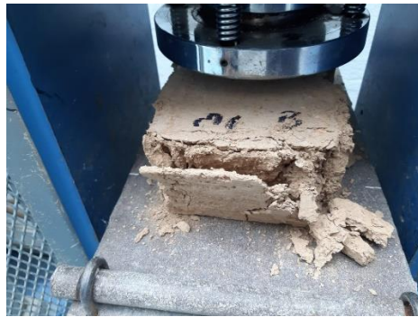
Figura 42. Fotografía de rotura, fuente: tomado de los resultados de los ensayos de laboratorio aplicados en servicios de ingeniería LTDA.
