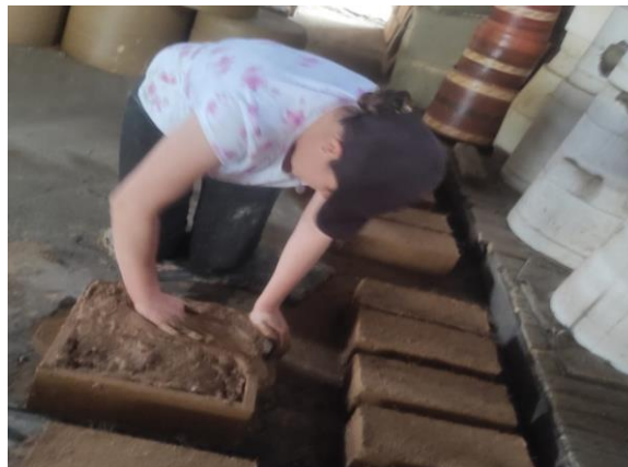
Figura 37. Moldeo de adobes reforzados con fibra de coco, fuente: elaboración propia.
