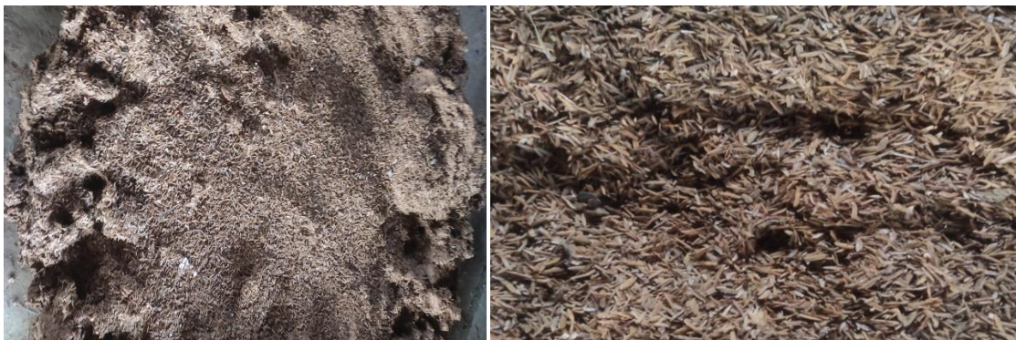
Figura 31. Mezcla de barro con cascarilla de arroz, fuente: elaboración propia.
