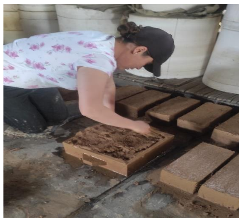
Figura 33. Moldeo de adobes reforzados con fibra de coco, fuente: elaboración propia.
