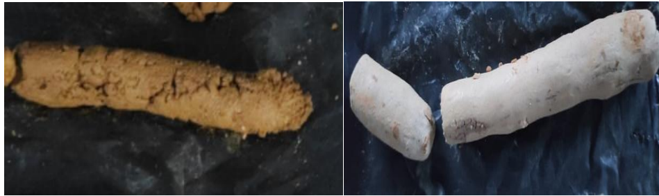
Figura 15. Resultados de la prueba del rollo, fuente: elaboración propia). Nota: Resultados de la prueba del rollo: 1) Tierra con adecuada cantidad de arcilla y arena. 2) Tierra con excesiva cantidad de arcilla.
