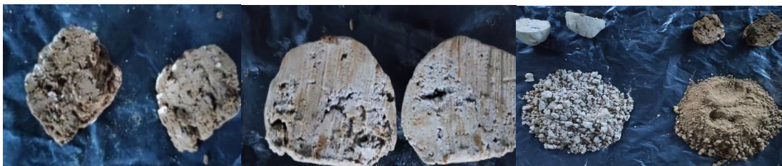
Figura 16. Resultados de la prueba de bola. Fuente: elaboración propia. Nota: Resultados de la prueba de bola: 1) Tierra con adecuada cantidad de arcilla. 2) Tierra con excesiva cantidad de arcilla. 3) comparación de muestras la de color blanco es arcilla para elabora artesanías tiene mayor de plasticidad para hacerle pruebas de compresión tiene más facilidad de agrietamientos y la amarilla es para realizar adobes, ladrillos o para la hacer mezcla para pegar los adobes.
