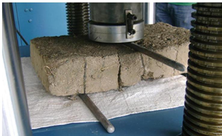
Figura 40. Prueba de flexión de adobe de ejemplo, fuente: tomada de la prueba de flexión de adobe de ejemplo. Ovando de la Cruz y Ruiz Castellanos, 2010.
