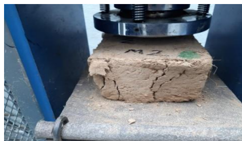
Figura 44. Fotografía de rotura, fuente: tomado de los resultados de los ensayos de laboratorio aplicados en servicios de ingeniería LTDA.
