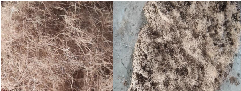
Figura 27. Mezcla de barro con fibras de coco, fuente: elaboración propia.
