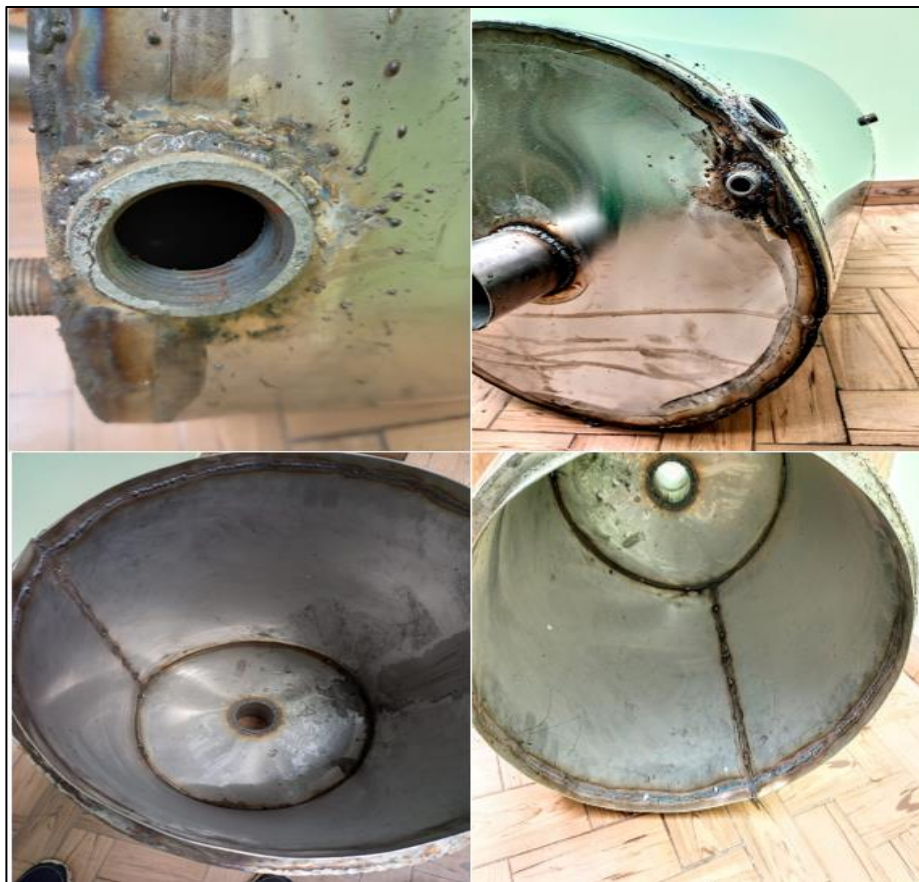
Figura 31. Construcción mecánica contenedor doble fondo. Fuente: Autores, 2021. *Al contenedor se le impidió pasar por el proceso de pulir, por lo cual se puede apreciar los cordones de soldadura, esto con el fin de mostrar visualmente las razones por las cuales no fue incorporado en la producción.
