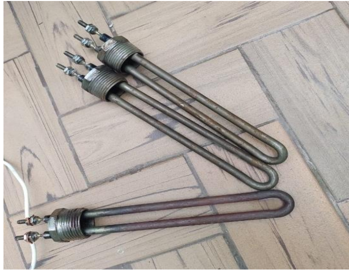
Figura 32. Resistencias implementadas en el prototipo. Fuente: Autores, 2021. *Se ubicaron cada 120° una de otra en la base cilíndrica del contenedor.
