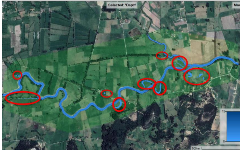
Figura 136. Modelado para el calado máximo de agua en un periodo de retorno de 50 años, fuente: Autores
