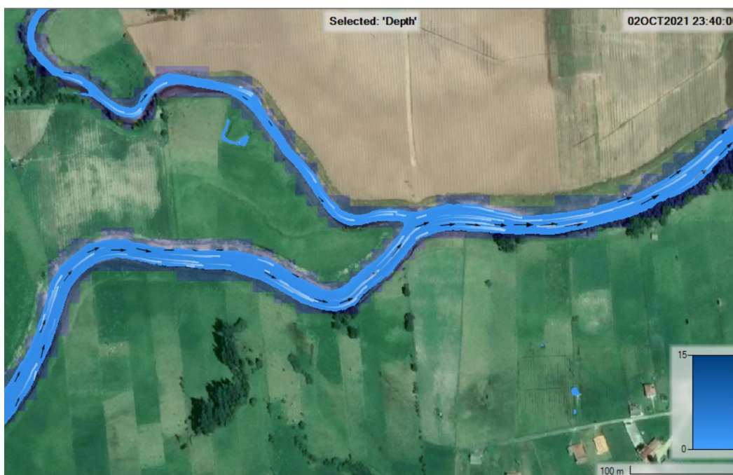
Figura 131. Dirección del flujo en la confluencia entre el río Chicamocha y Surba para un periodo de retorno de 25 años, fuente: Autores
