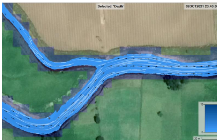
Figura 119. Dirección del flujo en la confluencia entre el río Chicamocha y Surba en un periodo de retorno de 5 años, fuente: Autores
