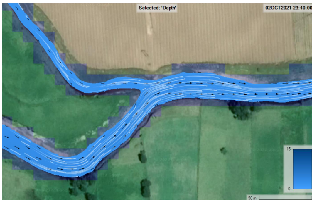
Figura 124. Dirección del flujo en la confluencia entre el río Chicamocha y Surba para un periodo de retorno de 10 años, fuente: Autores
