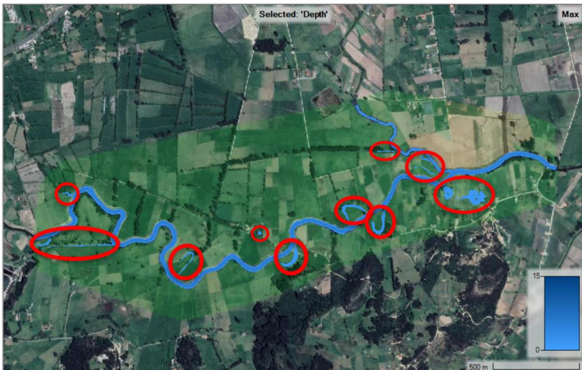
Figura 144. Modelado en el calado máximo de agua para un periodo de retorno de 100 años, fuente: Autores
