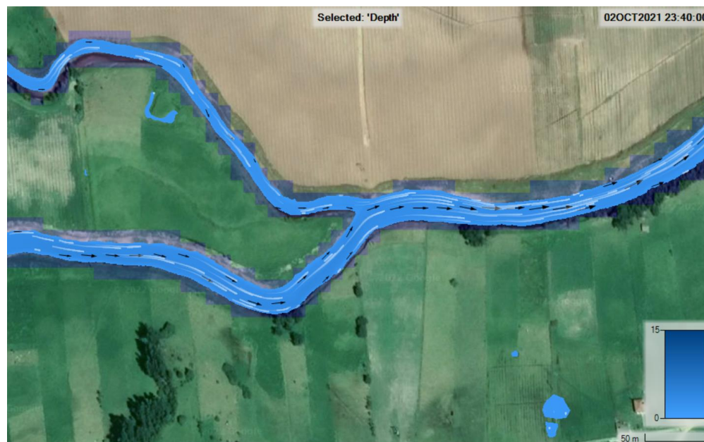
Figura 138. Dirección y comportamiento del flujo en la confluencia entre el río Chicamocha y Surba para un periodo de retorno de 50 años, fuente: Autores
