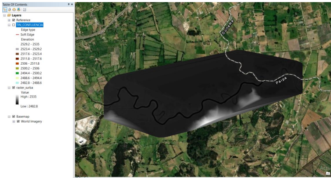
Figura 74. Ráster con escala de alturas a color de escala de grises, fuente: Autores
