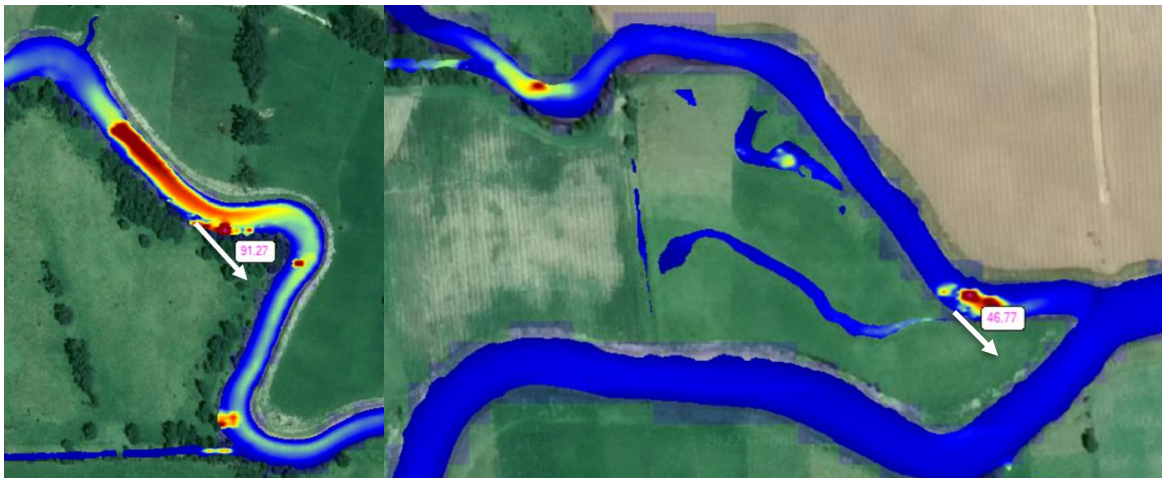
Figura 141. Velocidades en la sinuosidad del río Chicamocha y la confluencia con el Surba para un periodo de retorno de 50 años (velocidad máxima aproximada 91.27 m/s y 46.77 m/s), fuente: Autores
