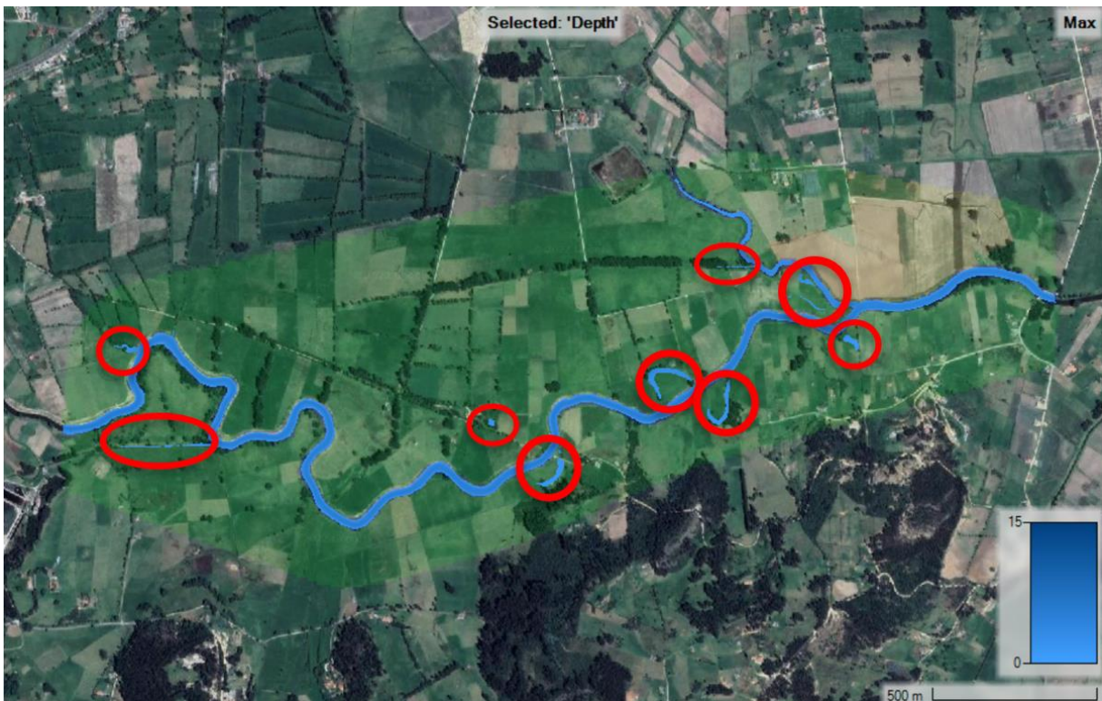
Figura 123. Modelado e identificación de zonas inundables en el calado máximo de agua en para un periodo de retorno de 10 años, fuente: Autores
