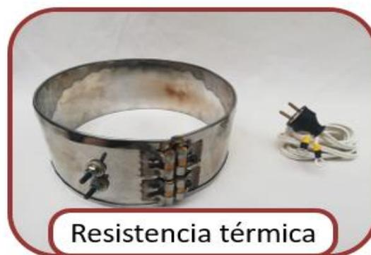
*Figura 1.* La resistencia térmica tipo abrazadera. Fuente: Autores de la investigación, 2020.
