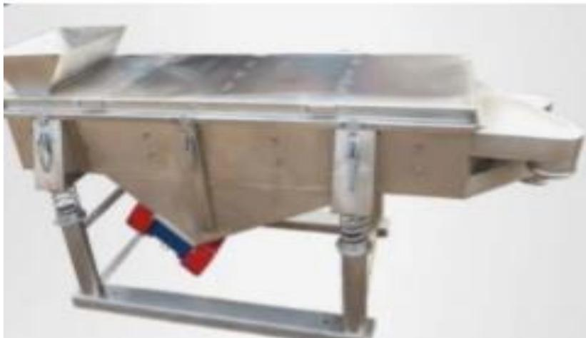
*Figura 9.* Tamiz vibratorio. Az3oeno. (s.f.). *Tolva vibrante.* Recuperado de: <https://www.az3oeno.com/maquina/tolva-vibrante/>.
